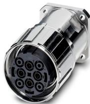
Connettore per apparecchi anteriore con dado zigrinato, diritto, Bloccaggio a vite, M40, numero poli: 4+3+PE, tipo di connessione del contatto: Femmina, O-ring assiale, 4x Ø4,2, schermata: sì, misura flangia: 40 mm x 40 mm, diametro cavi: 0 mm ... 0 mm, numero poli: 8, tipo di connessione: Connessione a crimpare, serie: SM, Questo articolo è in continuo adattamento. Alternativa senza piombo secondo RoHS II senza eccezione 6c (Pb < 0,1%) possibile in anticipo su richiesta.
