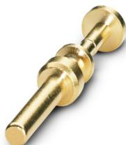
Contatto a crimpare, Spina, tornito, Contatto singolo, diametro contatti: 3,6 mm, intervallo di crimpatura: 0,75 mm<sup>2</sup> ... 1,5 mm<sup>2</sup>, Prodotto alternativo secondo RoHS II senza eccezione 6c (Pb < 0,1 %) cod. art.: 1242233
