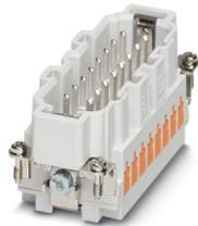
Inserto contatti, numero poli: 16+PE, dimensioni: B16, numero di connessioni per polo: 1, Spina, Attacco QUICKON, 500 V, 16 A, 0,34 mm<sup>2</sup> ... 2,5 mm<sup>2</sup>
