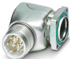
Connettore per apparecchi anteriore, angolato, orientabile, per bloccaggio standard e SPEEDCON, M23, numero poli: 5+PE, tipo di connessione del contatto: Spina, O-ring assiale, 4x Ø 3,2, schermata: sì, misura flangia: 26 mm x 26 mm, numero poli: 6, tipo di connessione: Connessione a crimpare, serie: SF
