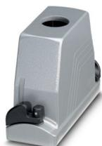
Custodia mobile HEAVYCON ADVANCE B24, rivestimento standard con polveri, con bloccaggio a baionetta, altezza 100 mm, con filettatura 1x M40, uscita cavo diritta
