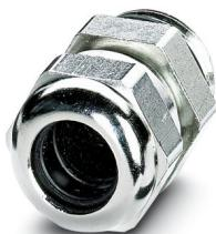
Pressacavi, diametro esterno cavo 4 mm ... 6 mm, schermatura: no, filettatura: Pg7, colore: argento
