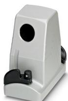
Custodia mobile HEAVYCON ADVANCE EMC B10, con bloccaggio a baionetta, altezza 100mm, con filettatura 1xM25, uscita cavo laterale
