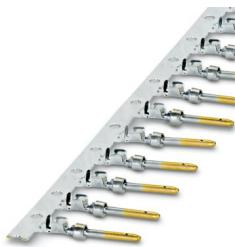
Contatto a crimpare, Spina, in rotolo, Nastro, numero di pezzi per nastro: 10000, diametro contatti: 1 mm, intervallo di crimpatura: 0,22 mm<sup>2</sup> ... 0,56 mm<sup>2</sup>, L'articolo è senza piombo secondo la direttiva RoHS II senza eccezione 6c (Pb < 0,1 %)
