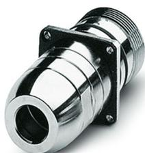
M23, Passaparete posteriore, serie: RC, diritto, schermati: sì, Bloccaggio a vite, Numero di poli: 17, Senso di rotazione: standard, tipo di connessione del contatto: Spina, Connessione a crimpare, Guarnizione piatta, 4xM3, Spessore della parete max.: 2,5 mm, diametro cavi: 4,5 mm ... 5,5 mm, codifica: N
