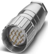
M23, Connettore per cavi, serie: RC, diritto, schermati: no, Bloccaggio a vite, Numero di poli: 16, Senso di rotazione: standard, tipo di connessione del contatto: Spina, A saldare a mano, codifica: N, Prodotto alternativo secondo RoHS II senza eccezione 6c (Pb < 0,1 %) cod. art.: 1241217
