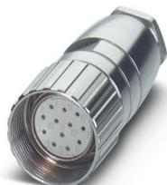
M23, Connettore per cavi, serie: RC, diritto, schermati: no, Bloccaggio a vite, Numero di poli: 12, Senso di rotazione: Invertito, tipo di connessione del contatto: Femmina, A saldare a mano, codifica: N, Prodotto alternativo secondo RoHS II senza eccezione 6c (Pb < 0,1 %) cod. art.: 1241106
