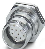
M23, Connettore per apparecchi posteriore, serie: RC, diritto, schermati: sì, Bloccaggio a vite, Numero di poli: 12, Senso di rotazione: standard, tipo di connessione del contatto: Femmina, Connessione a crimpare, O-ring assiale, Fissaggio centrale M25 x 1,5, Spessore della parete min.: 0,8 mm, Spessore della parete max.: 6,5 mm, codifica: N, Prodotto alternativo secondo RoHS II senza eccezione 6c (Pb < 0,1 %) cod. art.: 1241068
