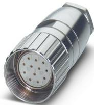
M23, Connettore per cavi, serie: RC, diritto, schermati: no, Bloccaggio a vite, Numero di poli: 8+1, Senso di rotazione: standard, tipo di connessione del contatto: Femmina, A saldare a mano, codifica: N, Prodotto alternativo secondo RoHS II senza eccezione 6c (Pb < 0,1 %) cod. art.: 1240642
