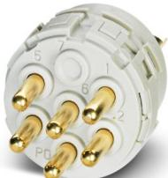
Inserto contatti, M23, numero poli: 7, tipo di connessione del contatto: Spina, A saldare a mano, serie: NC, RC, RM, TU, UC, Prodotto alternativo secondo RoHS II senza eccezione 6c (Pb < 0,1 %) cod. art.: 1240471
