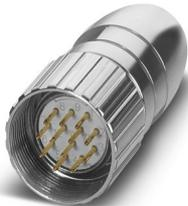
M23, Connettore per cavi, serie: RC, diritto, schermati: no, Bloccaggio a vite, Numero di poli: 6, Senso di rotazione: standard, tipo di connessione del contatto: Spina, A saldare a mano, codifica: N, Questo articolo è in continuo adattamento. Alternativa senza piombo secondo RoHS II senza eccezione 6c (Pb < 0,1%) possibile in anticipo su richiesta.
