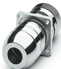
Passaparete anteriore, serie: RC, diritto, Bloccaggio a vite, M23, numero poli: 12, tipo di connessione del contatto: Femmina, Connessione a crimpare, O-ring radiale, 4x Ø 2,7 mm, schermata: sì, spessore della parete min.: 3 mm, spessore della parete max.: 7 mm, diametro cavi: 2 mm... 10,5 mm, Questo articolo è in continuo adattamento. Alternativa senza piombo secondo RoHS II senza eccezione 6c (Pb < 0,1%) possibile in anticipo su richiesta.
