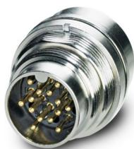
Connettore per apparecchi posteriore, diritto, Bloccaggio a vite, M16, numero poli: 14, tipo di connessione del contatto: Spina, O-ring assiale, Fissaggio centrale, schermata: no, numero poli: 14, tipo di connessione: Codoli, serie: PV
