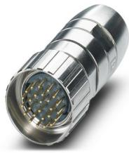
Connettore per cavi, diritto, Bloccaggio a vite, M27, numero poli: 26, tipo di connessione del contatto: Spina, schermata: sì, grado di protezione: IP67, diametro cavi: 2 mm ... 14,5 mm, numero poli: 26, tipo di connessione: Attacco a saldare, serie: HC, Prodotto alternativo secondo RoHS II senza eccezione 6c (Pb < 0,1 %) cod. art.: 1240137
