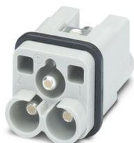
Inserto contatti, numero poli: 2+PE, dimensioni: D7, contatti di potenza: 2, Spina, Connessione a vite assiale, 400 V, 40 A, 4 mm<sup>2</sup> ... 10 mm<sup>2</sup>, applicazione: Potenza
