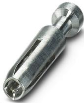
Contatto a crimpare, diametro contatti: 2,5 mm, tornito, Femmina, materiale contatti: Rame-nichel (costantana), sezione di connessione: 0,5 mm<sup>2</sup> ... 0,5 mm<sup>2</sup>, AWG 20
