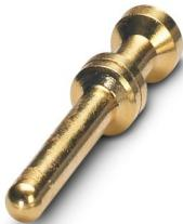
Contatto a crimpare, diametro contatti: 2,5 mm, tornito, Spina, materiale contatti: Lega di rame, superficie contatti: dorato, sezione di connessione: 0,14 mm<sup>2</sup> ... 0,37 mm<sup>2</sup>, AWG 22 ... 26
