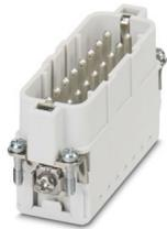
Inserto contatti, numero poli: 16+PE, dimensioni: D25, Spina, Connessione Push-in, 250 V, 16 A, 0,14 mm<sup>2</sup> ... 2,5 mm<sup>2</sup>
