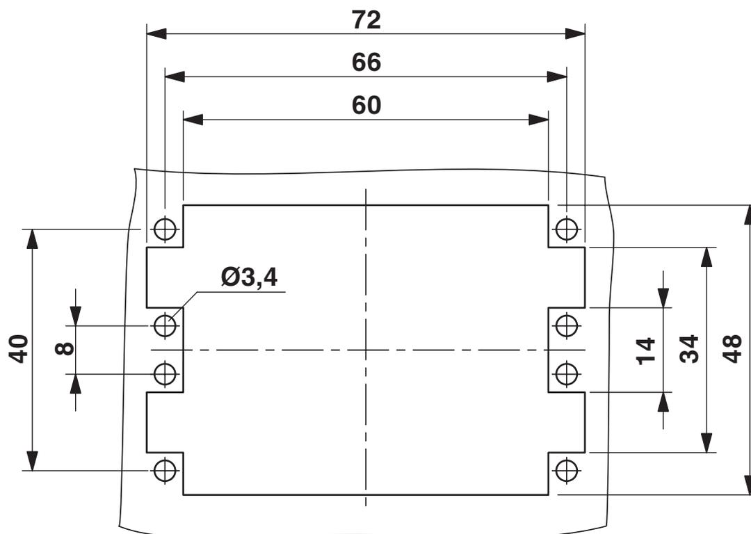
Sezione di montaggio nell'impiego senza custodia
