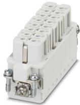
Inserto contatti, numero poli: 16+PE, dimensioni: D25, numero di connessioni per polo: 1, Femmina, Connessione Push-in, 250 V, 16 A, 0,14 mm<sup>2</sup> ... 2,5 mm<sup>2</sup>
