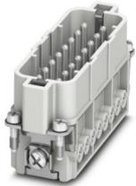
Inserto contatti, numero poli: 16+PE, dimensioni: D25, Spina, Connessione a vite, 250 V, 16 A, 0,5 mm<sup>2</sup> ... 2,5 mm<sup>2</sup>
