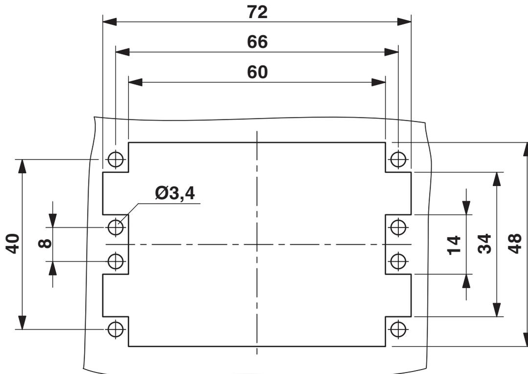
Sezione di montaggio nell'impiego senza custodia
