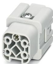
Inserto contatti, numero poli: 4+PE, dimensioni: D7, numero di connessioni per polo: 1, Femmina, Connessione Push-in, 230 V, 10 A, 0,14 mm<sup>2</sup> ... 1,5 mm<sup>2</sup>
