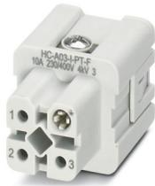
Inserto contatti, numero poli: 3+PE, dimensioni: D7, numero di connessioni per polo: 1, Femmina, Connessione Push-in, 230 V/400 V, 10 A, 0,14 mm<sup>2</sup> ... 1,5 mm<sup>2</sup>
