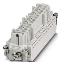
Inserto contatti, numero poli: 24+PE, dimensioni: B24, Femmina, Connessione a crimpare, 500 V, 16 A, 0,5 mm<sup>2</sup> ... 4 mm<sup>2</sup>
