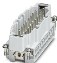
Inserto contatti, numero poli: 16+PE, dimensioni: B16, Spina, Connessione a vite, 500 V, 16 A, 0,5 mm<sup>2</sup> ... 2,5 mm<sup>2</sup>
