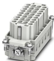
Inserto contatti, numero poli: 32+PE, dimensioni: B16, numero di connessioni per polo: 1, Femmina, Connessione a crimpare, 500 V, 16 A, 0,5 mm<sup>2</sup> ... 4 mm<sup>2</sup>
