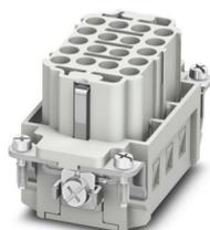
Inserto contatti, numero poli: 18+PE, dimensioni: B10, numero di connessioni per polo: 1, Femmina, Connessione a crimpare, 500 V, 16 A, 0,5 mm<sup>2</sup> ... 4 mm<sup>2</sup>
