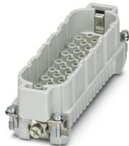
Inserto contatti, numero poli: 64+PE, dimensioni: B24, numero di connessioni per polo: 1, Spina, Connessione a crimpare, 250 V, 10 A, 0,14 mm<sup>2</sup> ... 2,5 mm<sup>2</sup>, applicazione: Segnale
