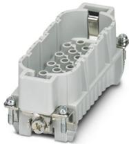
Inserto contatti, numero poli: 40+PE, dimensioni: B16, numero di connessioni per polo: 1, Spina, Connessione a crimpare, 250 V, 10 A, 0,14 mm<sup>2</sup> ... 2,5 mm<sup>2</sup>, applicazione: Segnale
