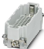
Inserto contatti, numero poli: 72+PE, dimensioni: B16, numero di connessioni per polo: 1, Spina, Connessione a crimpare, 250 V, 10 A, 0,14 mm<sup>2</sup> ... 2,5 mm<sup>2</sup>, applicazione: Segnale
