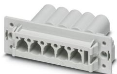
Portacontatti, Serie di prodotti: VARIOCON, tipo: VC3, colore: grigio chiaro, numero poli: 5, tensione di dimensionamento: 690, corrente nominale: 70 A, Tipo di connessione: Connessione a crimpare, Tipo di connessione del contatto: Spina, i connettori possono essere estratti esclusivamente in assenza di tensione.
