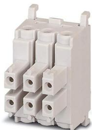
Inserto contatti, Serie di prodotti: VARIOCON, colore: grigio chiaro, numero poli: 6, sezione del conduttore min.:  $0,14 \text{ mm}^2$ , sezione del conduttore max.:  $1,5 \text{ mm}^2$ , tensione di dimensionamento: 250, corrente nominale: 10 A, Tipo di connessione: Connessione a vite, Tipo di connessione del contatto: Femmina, i connettori possono essere estratti esclusivamente in assenza di tensione.
