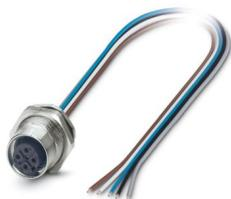
Connettore per apparecchi posteriore, 5-poli, Femmina, diritto, M12-SPEEDCON, codifica: A, su estremità conduttore libera, Montaggio posteriore, Pg9, Fili singoli, lunghezza cavo: 1,5 m, 0,34 mm<sup>2</sup>, Filo in TPE, saldato
