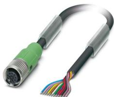
Cavo sensore/attuatore, 12-poli, PVC, nero RAL 9005, estremità conduttore libera, su Connettore femmina diritto M12 SPEEDCON, codifica: A, lunghezza cavo: 15 m
