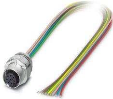
Connettore per apparecchi anteriore, Universale, 8-poli, Femmina, diritto, M12-SPEEDCON, codifica: A, su estremità conduttore libera, Montaggio anteriore, M16 x 1,5, Fili singoli, lunghezza cavo: 1 m, 0,25 mm<sup>2</sup>, Filo in TPE, saldato, Questo articolo è in continuo adattamento. Alternativa senza piombo secondo RoHS II senza eccezione 6c (Pb < 0,1%) possibile in anticipo su richiesta.
