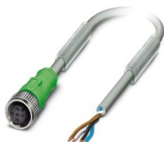
Cavo sensore/attuatore, 4-pol., PUR senza alogenati, resistente agli spruzzi di saldatura, altamente flessibile, grigio RAL 7001, estremità conduttore libera, su Connettore femmina diritto M12, codifica: A, lunghezza cavo: 10 m, per robot e catene portacavi
