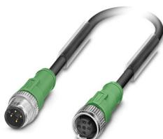
Cavo sensore/attuatore, 4-pol, PUR senza alogenati, resistente agli spruzzi di saldatura, altamente flessibile, grigio RAL 7001, Maschio diritto M12, codifica: A, su Connettore femmina diritto M12, codifica: A, lunghezza cavo: 5 m
