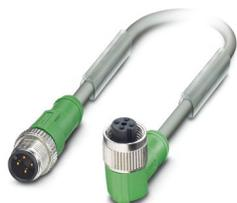
Cavo sensore/attuatore, 4-poli, PUR senza alogenati, resistente agli spruzzi di saldatura, altamente flessibile, grigio RAL 7001, Maschio diritto M12, codifica: A, su Connettore femmina angolato M12, codifica: A, lunghezza cavo: 1,5 m, per robot e catene portacavi
