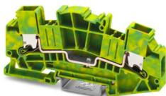
Morsetti comp. per conduttori terra, tipo di connessione: Connessione Push-X, Sezione di dimensionamento: 6 mm<sup>2</sup>, sezione: 0,5 mm<sup>2</sup> - 10 mm<sup>2</sup>, colore: giallo-verde
