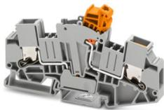
Morsetto sezionatore per conv. misura, tensione nominale: 800 V, corrente nominale: 30 A, tipo di connessione: Connessione Push-X, Sezione di dimensionamento: 6 mm<sup>2</sup>, sezione: 0,5 mm<sup>2</sup> - 10 mm<sup>2</sup>, colore: grigio
