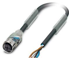
Cavo sensore/attuatore, 4-poli, PUR senza alogenati, grigio-nero RAL 7021, estremità conduttore libera, su Connettore femmina diritto M12, codifica: A, con 3 LED, lunghezza cavo: 10 m
