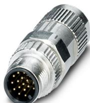
Connettore, Universale, 17-poli, Maschio diritto M12 SPEEDCON, codifica: A, Connessione rapida Piercecon®, materiale zigrinato: Pressogetto di zinco, nichelato, diametro esterno conduttore 5,4 mm ... 8,2 mm
