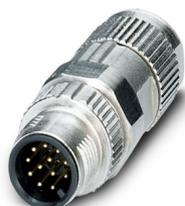
Connettore, Universale, 12-poli, Maschio diritto M12 SPEEDCON, codifica: A, Connessione rapida Piercecon®, materiale zigrinato: Pressogetto di zinco, nichelato, diametro esterno conduttore 5,4 mm ... 8,2 mm
