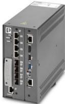
Switch Managed con quattro porte RJ45 per 10/100/1000 MBit/s, quattro porte SFP per 100/1000 MBit/s, coprocessore con Intel Atom® E3940 con 8 GB di memoria di lavoro, sistema operativo: Windows® 11 Pro, temperatura di esercizio -40°C ... +70°C, alimentazione di tensione nominale 24 V DC
