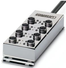
Scatola di distribuzione, applicazione: Industria alimentare, tipo di connessione: Connettore femmina M12 Acciaio inossidabile, numero degli slot: 8, numero poli: 5, codifica: A, occupazione slot: doppi, segnalazione di stato: sì, PNP; connessione linea principale: Attacco fisso 180°, PVC, lunghezza cavo: 5 m, schermatura: no
