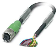
Cavo sensore/attuatore, 17-poli, PVC, nero RAL 9005, estremità conduttore libera, su Connettore femmina diritto M12 SPEEDCON, codifica: A, lunghezza cavo: 5 m
