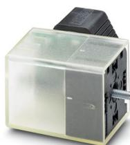
Connettore sensore/attuatore, 4 poli, connettore per valvole tipo A, con connessione QUICKON, con LED rosso, sezione di collegamento da 0,34 a 0,75 mm<sup>2</sup>, con un ingresso per cavo a sezione circolare da 5,6 a 9 mm
