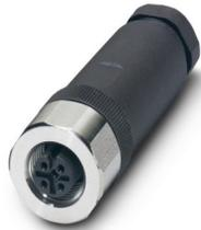
Connettore, Universale, 4-poli, Femmina diritto M12, codifica: A, Connessione a vite, materiale zigrinato: Acciaio legato 1.4404, connessione a vite per cavo Pg9, diametro esterno conduttore 6 mm ... 8 mm
